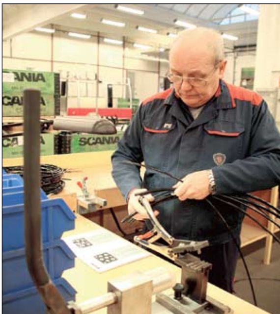
Montaż rurek plastikowych do multikonektorów na zdjęciu Tadeusz Wojtko
